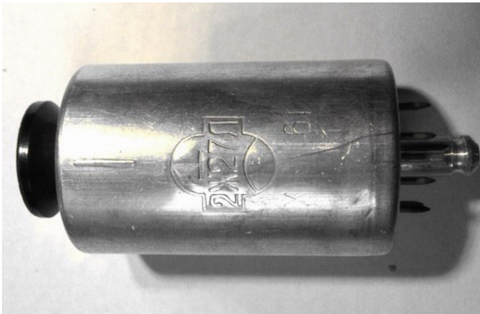
2Zs27L pentóda lecsavarható szervizkalappal, gyártva 1961. október
