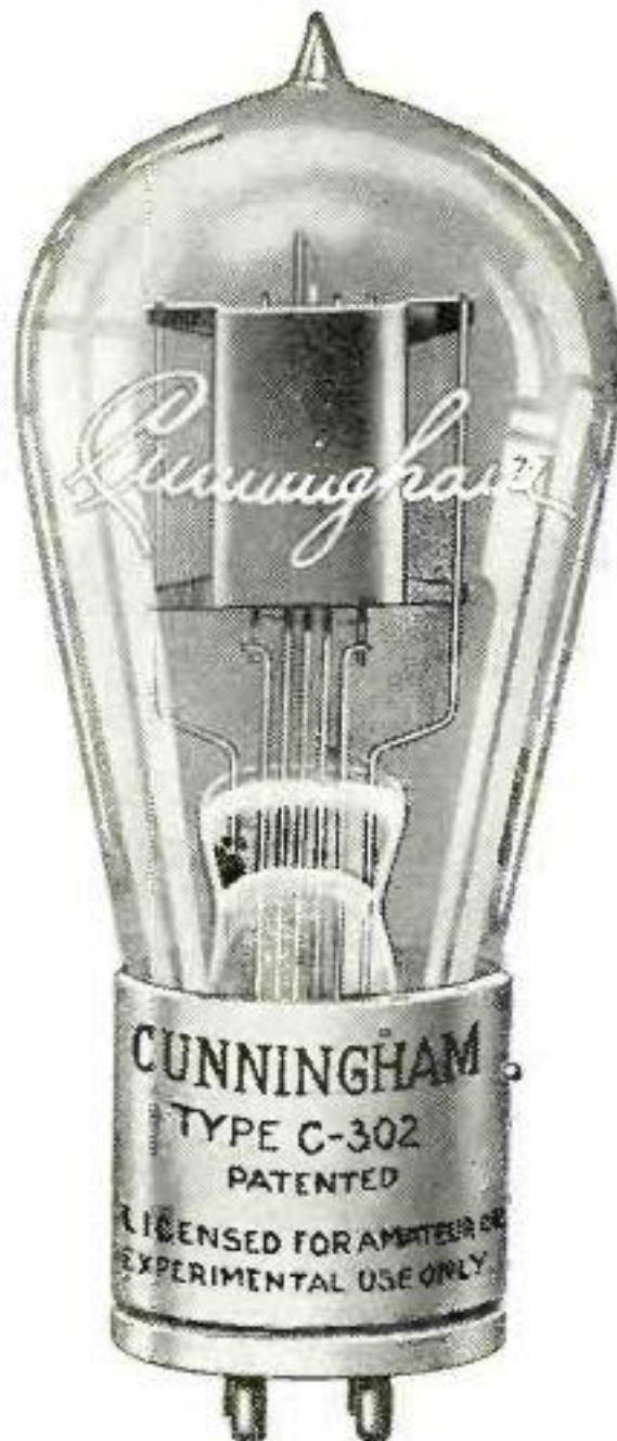
C-302 típusú, szabványos trióda 1921-ből, 5 W-os. „Csak amatőr és kísérleti célú felhasználása engedélyezett”
